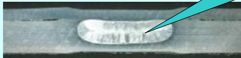
溶接部断面写真
